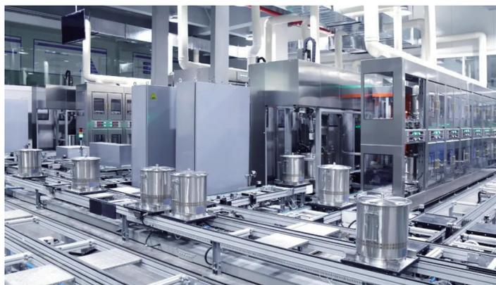
图4 集约化的煎药中心可实现中药饮片调剂与煎煮自动化
