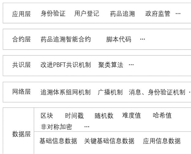
图5 基于区块链技术的药品追溯体系整体框架图
