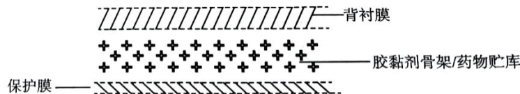
图4 胶黏剂分散型透皮给药制剂结构示意图
