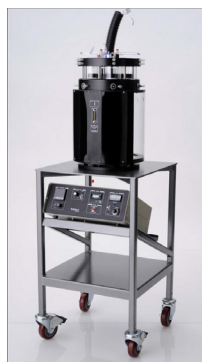
图1 Hicycle System 人工心脏瓣膜疲劳寿命测试仪
